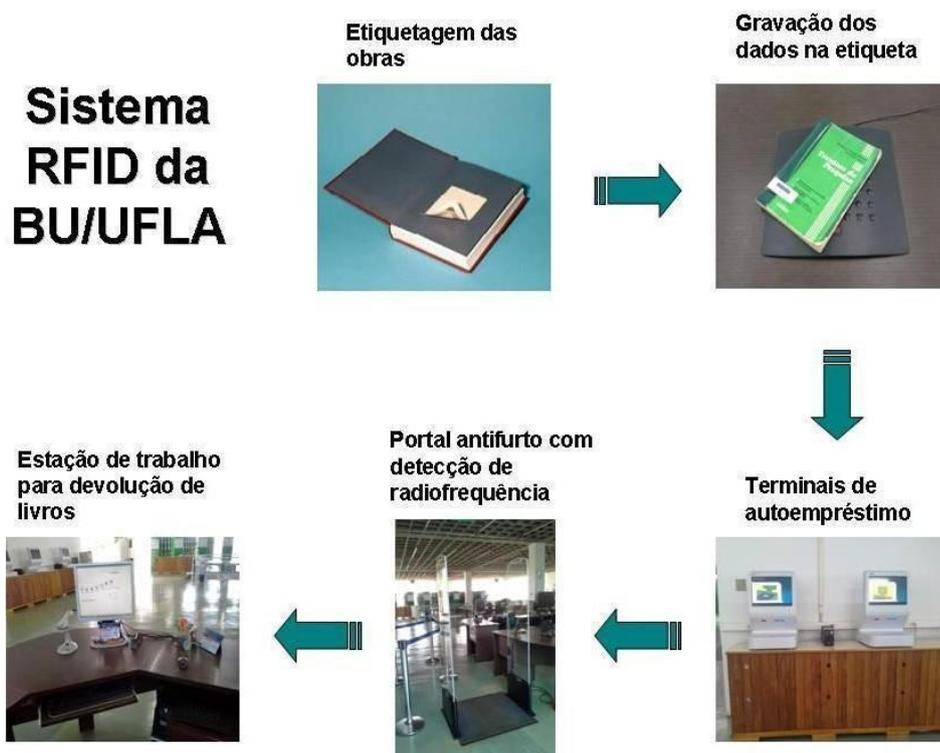
Legenda: O sistema de radiofrequência da BU/UFLA é constituído por etiquetas RFID, um pad eletrônico, terminais de autoempréstimo e um portal de detecção de radiofrequência.
